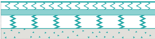
Prinsipiell oppbygging av kombielastisk gulv
