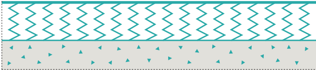
Prinsipiell oppbygging av punktlastisk gulv
